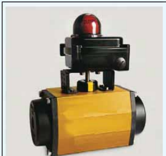
Attuatore pneumatico serie AP DA/SR con finecorsa meccanici, antideflagranti EExd, pneumatici, di prossimità amplificati PNP ed a sicurezza intrinseca EExia Namur racchiusi in box stagno IP 67.
