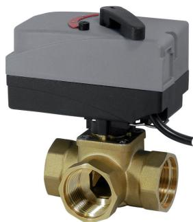
**IVR MOTORHEAD MIX EASY 230V 110s:** Servocomando BIDIREZIONALE (SPDT) – ruota di 90° in senso orario e antiorario, alternativamente nelle due direzioni definite, per le manovre di apertura e chiusura - SENZA RELÈ - controllo a TRE PUNTI: neutro cavo blu, fase cavo marrone direzione senso orario, fase controllo cavo nero senso antiorario.
